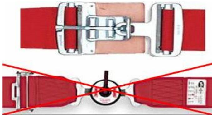
Figura B-45 – Tipo de fivela permitido (cima) e não permitido (baixo)
