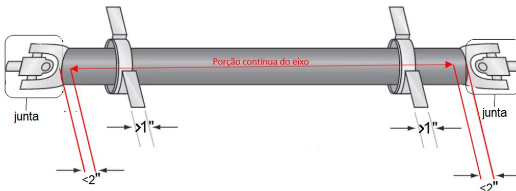
**Figura B-77 – Seção contínua do eixo e dimensões dos arcos de segurança**
