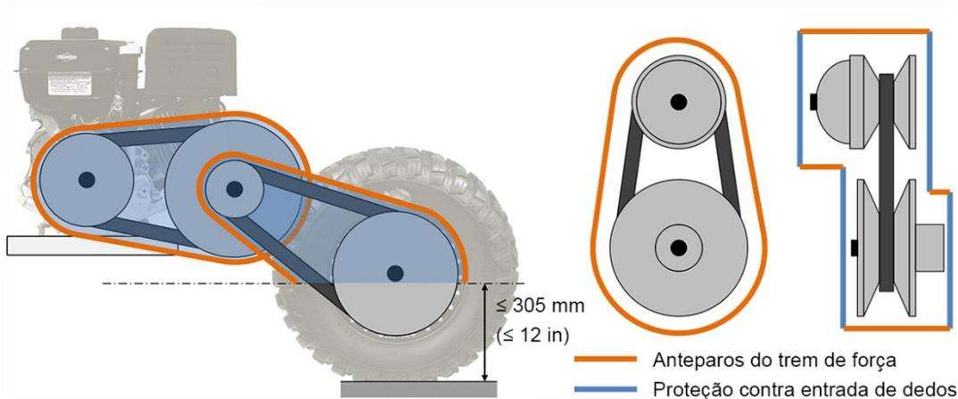
Figura B-72 – Anteparos do trem de força e proteção de entrada de dedos
