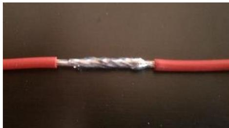
Figura B-18 – Emenda adequadamente soldada
