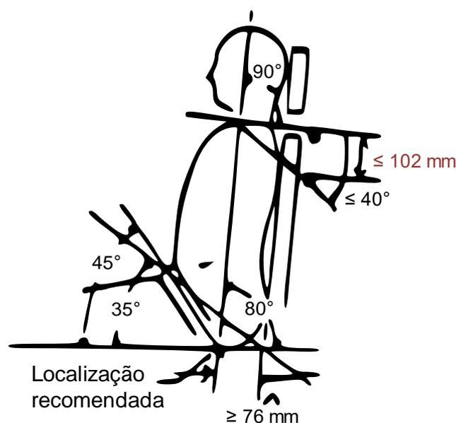
Figura B-48 – Posicionamento das tiras sobre os ombros e sobre a cintura
