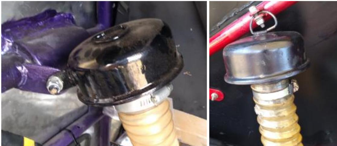
Figura B-7 – Exemplos de soluções adequadas para fixação do *hood*
