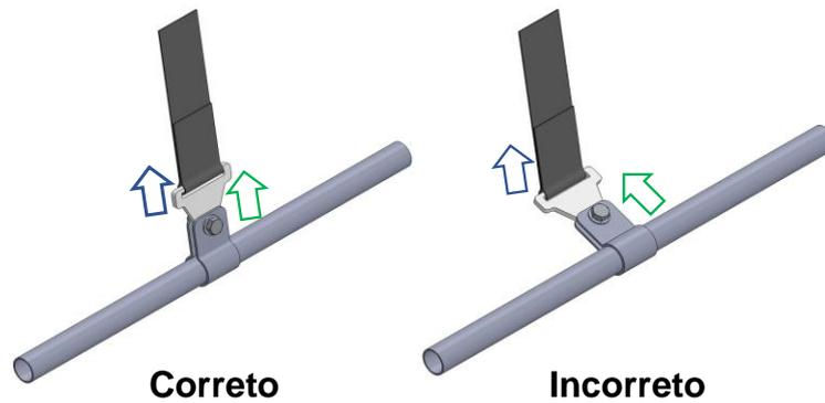
Figura B-53 – Carregamento das abas de suporte aceitável (esq.) e inaceitável (dir.)
