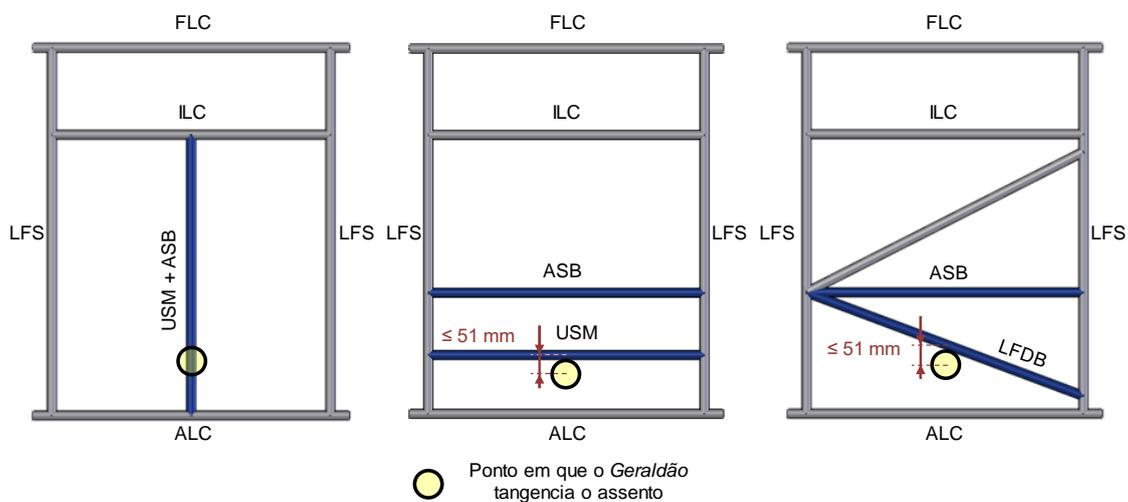
Figura B-33 – Exemplo de três configurações aceitáveis para o Under Seat Member e membro Anti-Submarine Seat Belt
