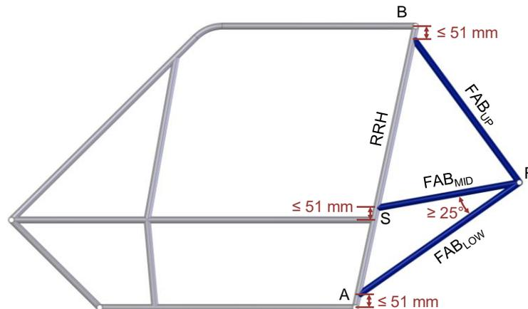
Figura B-36 – Configuração do travamento traseiro.
