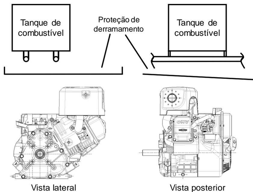
Figura B-65 – Exemplos de instalação da proteção de derramamento
