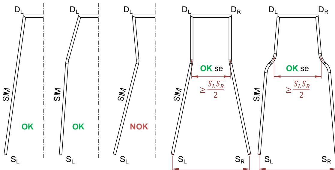
Figura B-34 – Vista superior dos *Side Impact Members* e configurações aceitáveis e inaceitáveis
