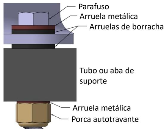
Figura B-60 – Disposição dos elementos de fixação do tanque ao seu suporte
