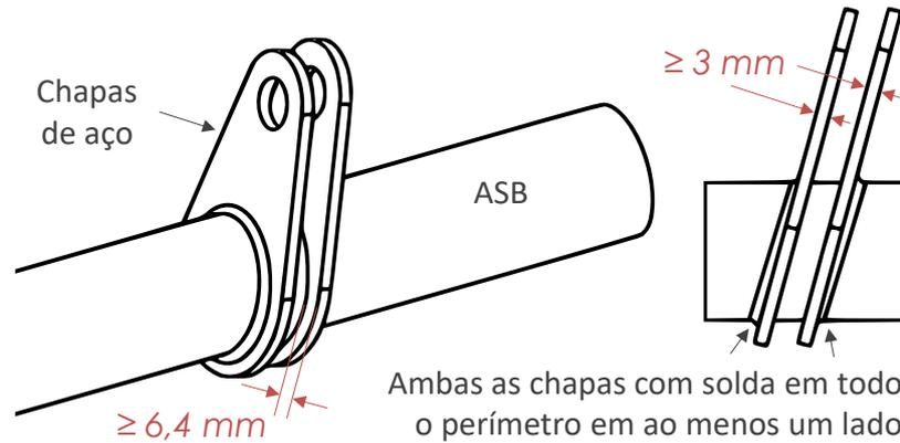
Figura B-57 – Fixação da tira antissubmarina em membro ASB longitudinal
