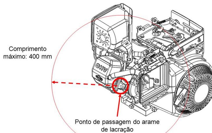
Figura B-4 – Posicionamento do lacre no motor
