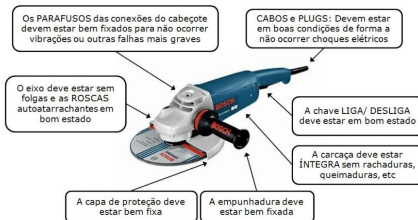
Figura C-3 – Esmerilhadeira com os requisitos de funcionamento
