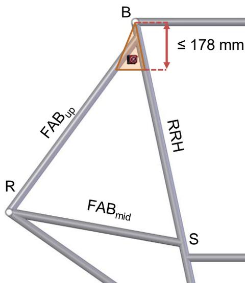
Figura B-11 – Posicionamento da chave geral externa
