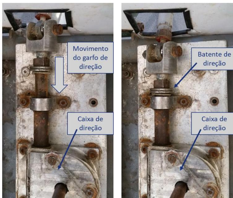
Figura B-67 – Exemplo de batente de direção
