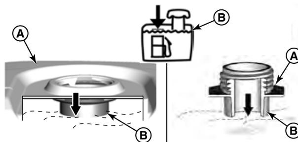
Figura B-66 – Nível máximo de combustível (B) dentro do tanque (A)
