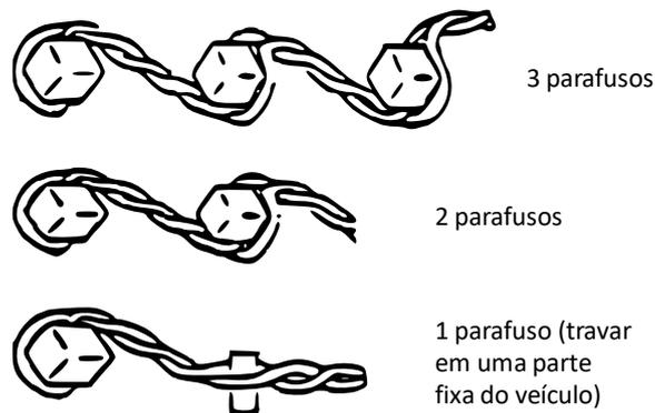
Figura B-69 – Procedimento para utilização adequada de freio em parafusos
