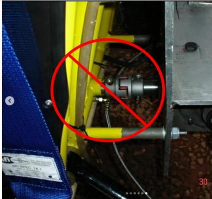
Figura B-78 –Exemplo de transmissão seccionando os membros da gaiola: inaceitável
