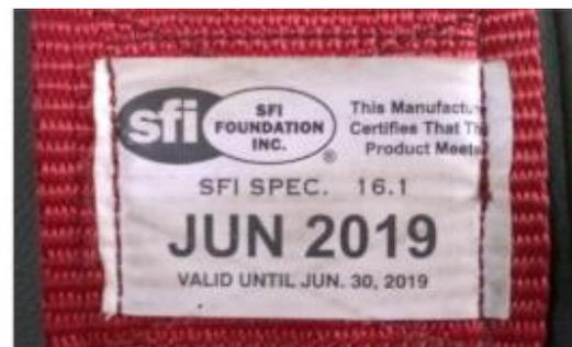
Figura B-46 – Modelos de etiqueta com data de fabricação (esq.) e data de validade (dir.) de cintos certificados na norma SFI 16.1
