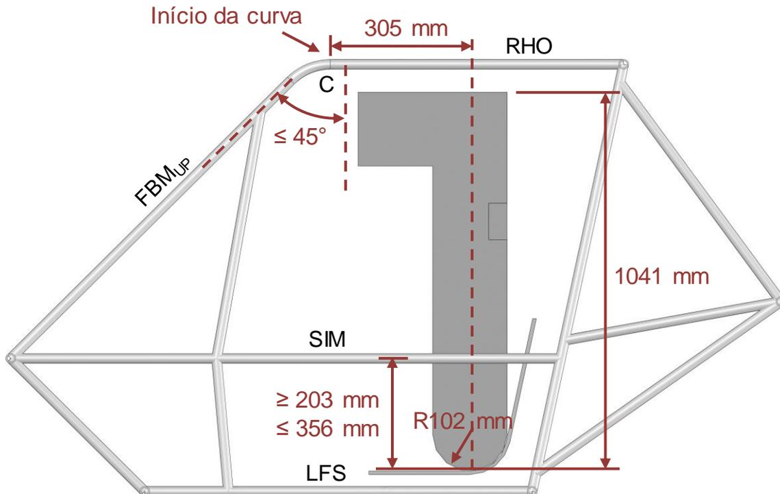
Figura B-31 – Alturas dos membros SIM e RHO e posição do ponto C
