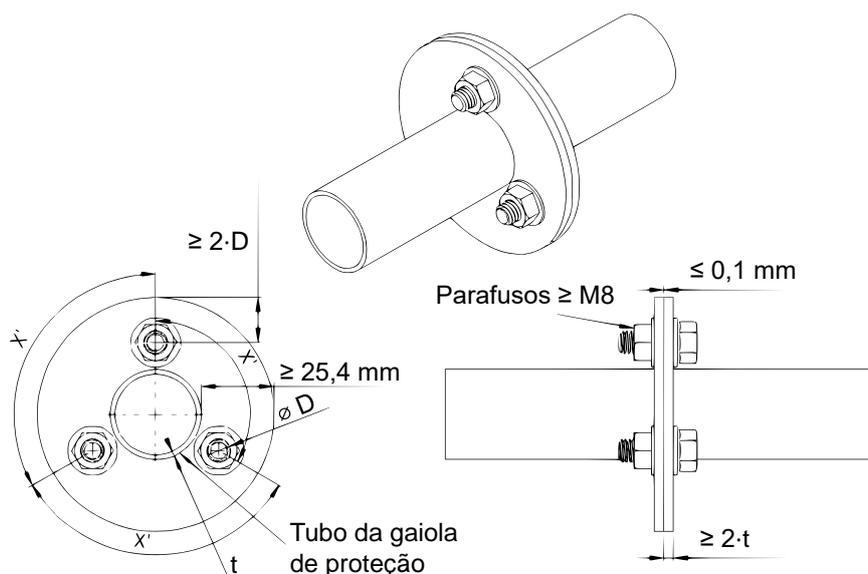
Figura B-41 – Exemplo de união de tubos por flanges
