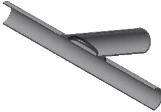
Figura B-40 – Corte para visualização da penetração da solda
