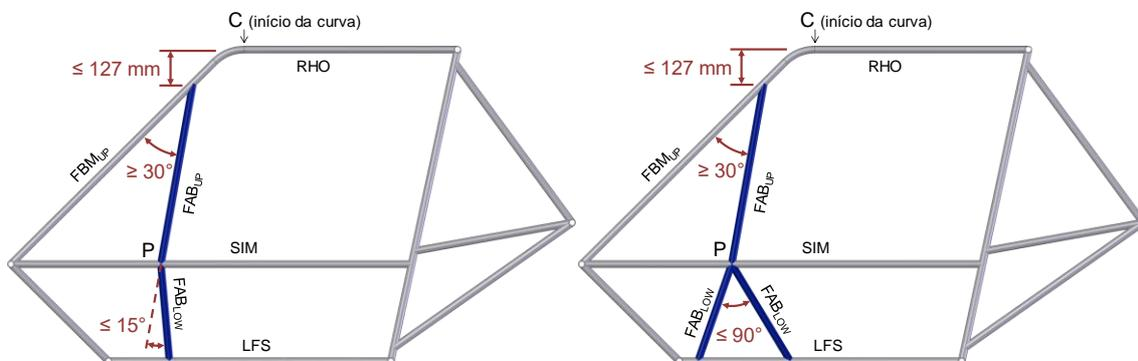
Figura B-35 – Configurações do travamento dianteiro.
