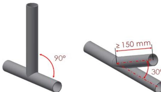
Figura B-39 – Exemplos de amostras soldadas
