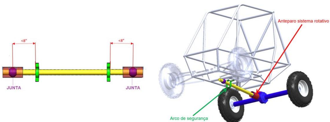
Figura B-80 – Posição dos arcos de segurança em eixos totalmente suspensos (esq.) e em eixos semi suspensos (dir.)
