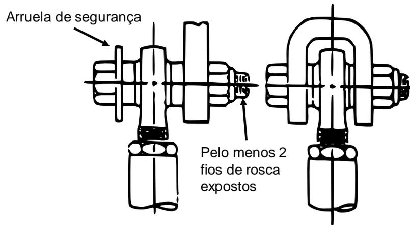
Figura B-71 – Conexões em cisalhamento simples (esq.) e duplo (solução recomendada, dir.)
