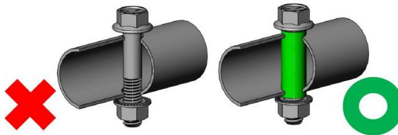
Figura B-42 – Reforço por luva soldada no caso de furo na gaiola
