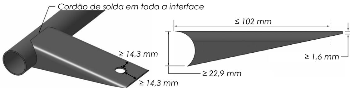
Figura B-61 – Requisitos dimensionais de abas de suporte para tanque *Pyrotect*
