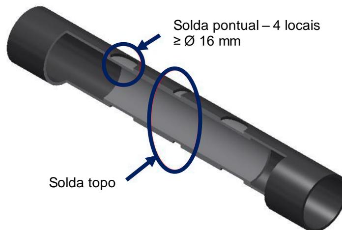
Figura B-38 – Exemplo de reforço por luva soldada
