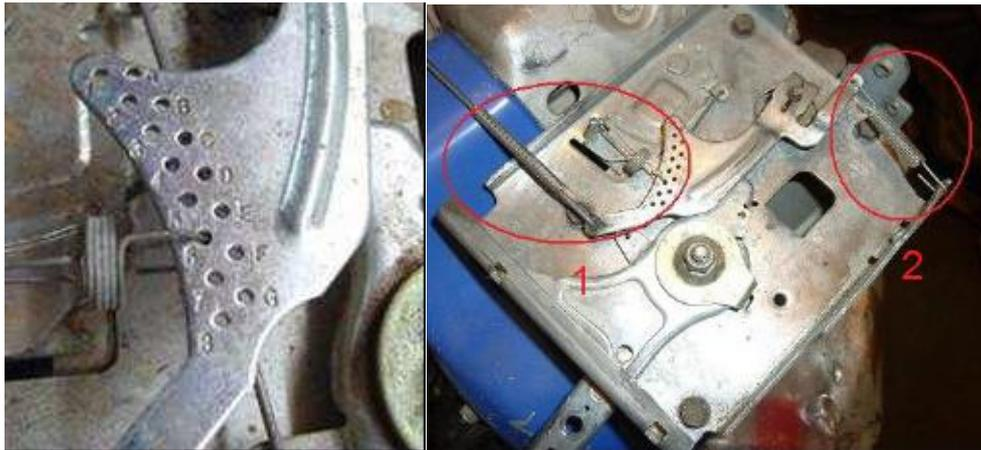
Figura B-2 – Posição da mola do governador (esq.) e mecanismos de ajuste (dir.) para motor série 20
