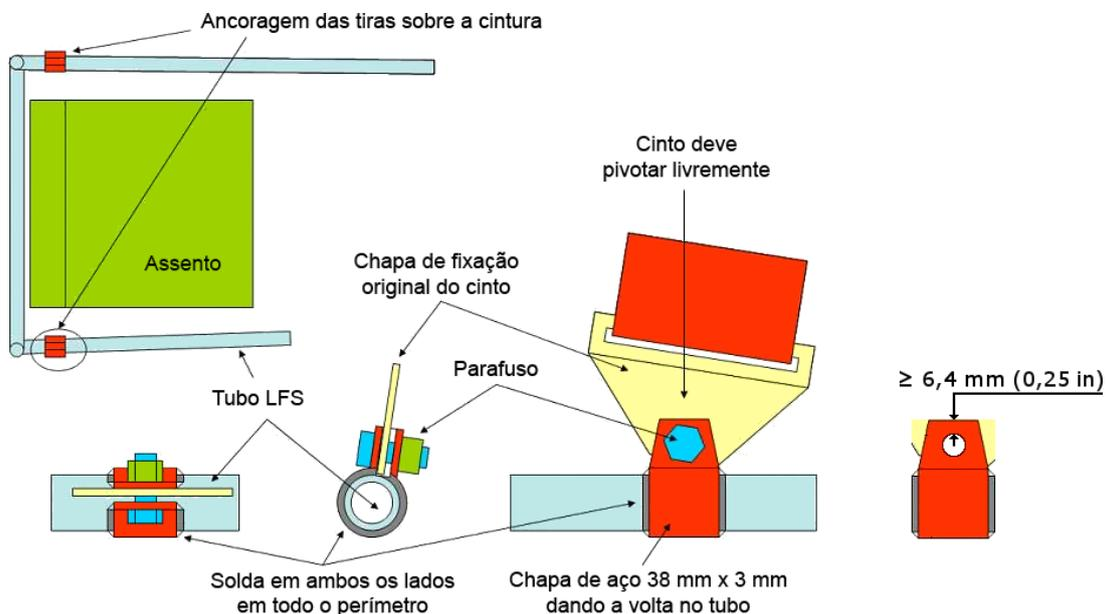
Figura B-52 – Fixação das tiras sobre a cintura
