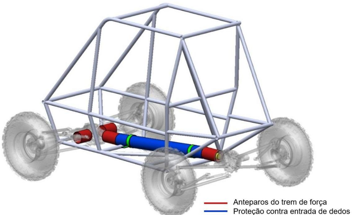
Figura B-73 – Anteparos do trem de força e proteção de entrada de dedos dentro do cockpit
