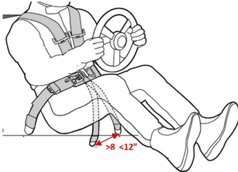
Figura B-56 – Posicionamento de duas tiras antissubmarina
