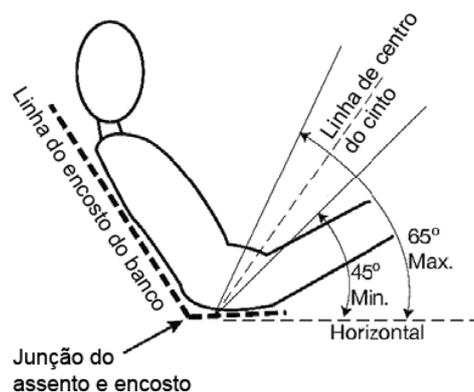
Figura B-51 – Posicionamento das tiras sobre a cintura
