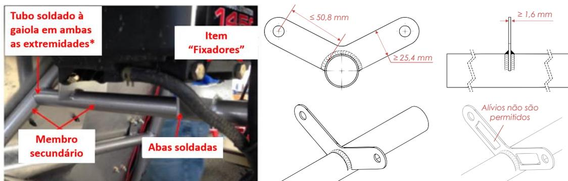
Figura B-62 – Fixação de tanque *Briggs & Stratton*
