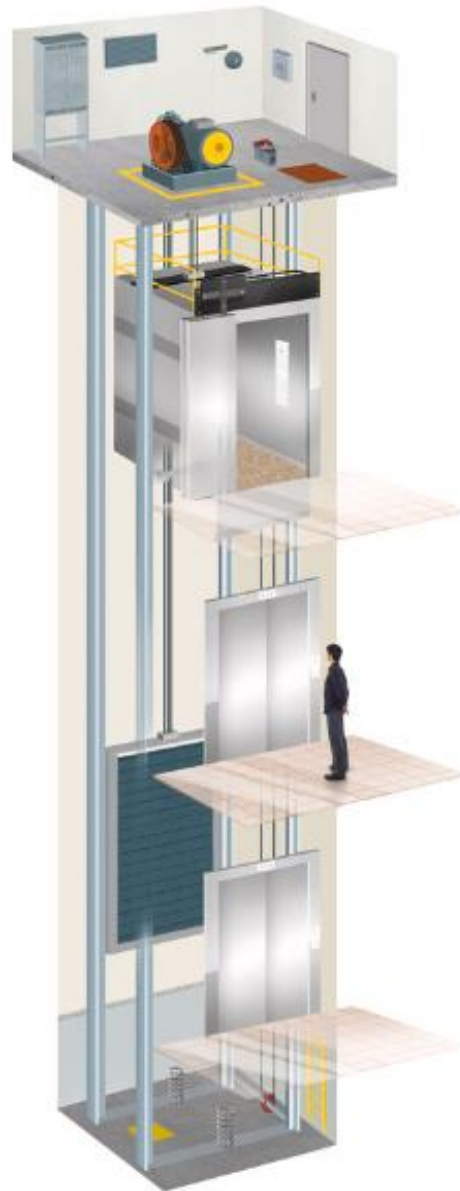
Com casa de máquinas
