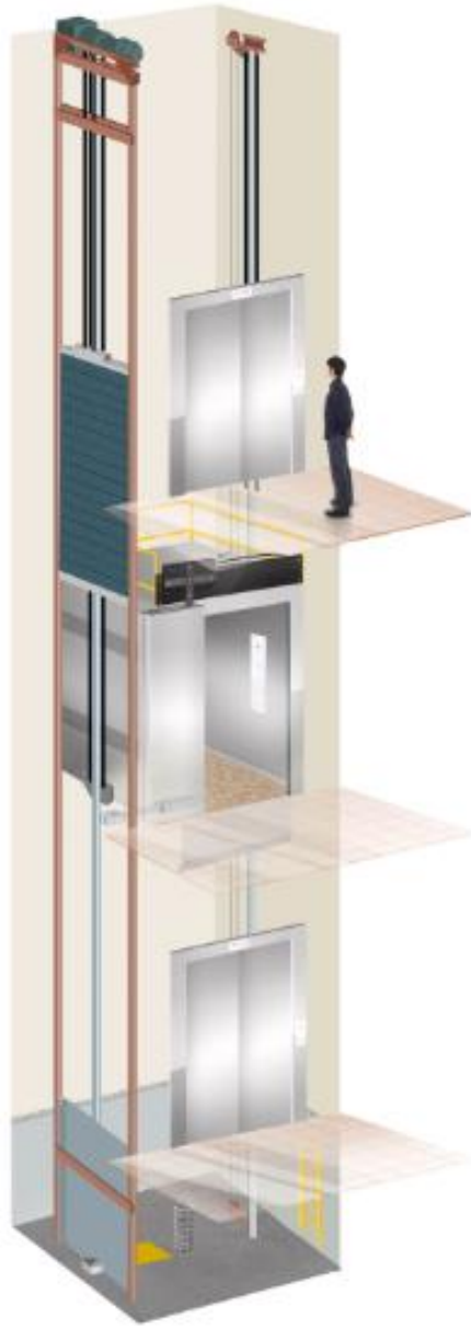
Sem casa de máquinas
