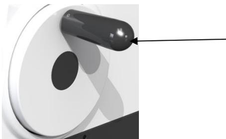
Não substitua as Navalhas de Corte sem Travar o Volante
