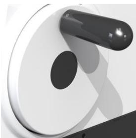
Gire sempre a roda de mão de maneira uniforme e em velocidade compatível com a dureza da amostra sob seccionamento.
