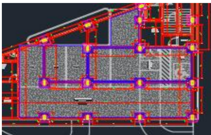
Área de aplicação do asfalto = 205m 2
