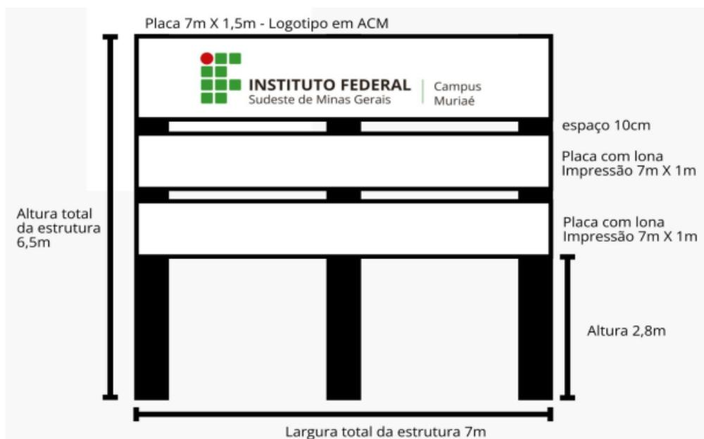
Figura 2 - Simulação dos letreiros instalados
