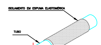
DETALHE PARA ISOLAMENTO TÓMICO DA TUBULAÇÃO INTERNA S/ ESCALA
