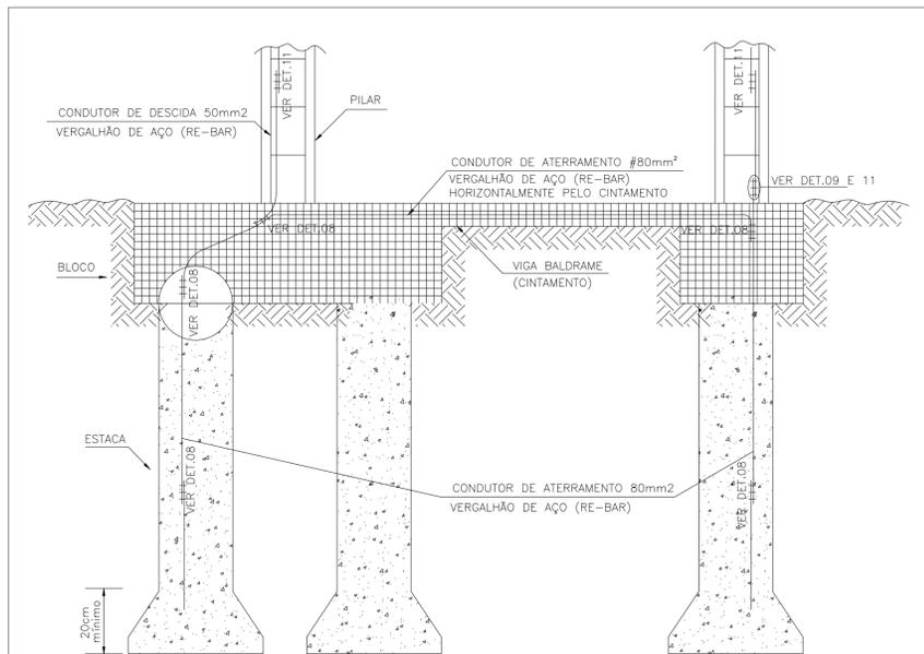
DETALHE 1 – ATERRAMENTO NOS TUBULÕES OU ESTACAS ESCAVADAS E RE-BAR PELO CINTAMENTO SEM ESCALA
